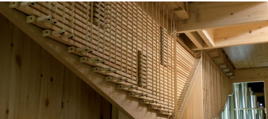
Wellenbrett des Schwellwerks mit Abstrakten
